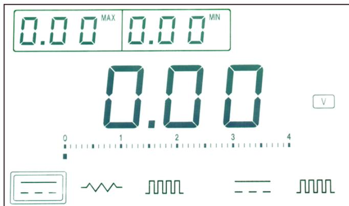
Рис. 4. Изображение на экране при отсоединенных зажимах сигнального кабеля
