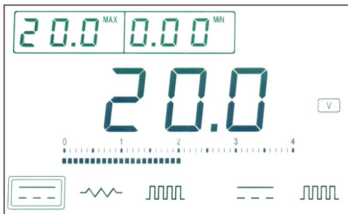
Рис. 5. Экран при измерении напряжения 20 вольт постоянного тока
