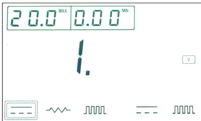
Рис. 6. При напряжении, которое превышает 40 вольт, на экране отображается цифра «1»
